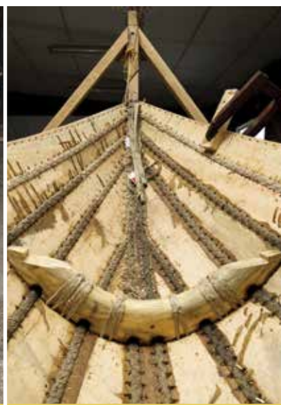
Fig. 3 : Détail des assemblages par ligatures. © Photo Ch. Durand, Centre Camille Jullian, AMU-CNRS, Aix-en-Provence
